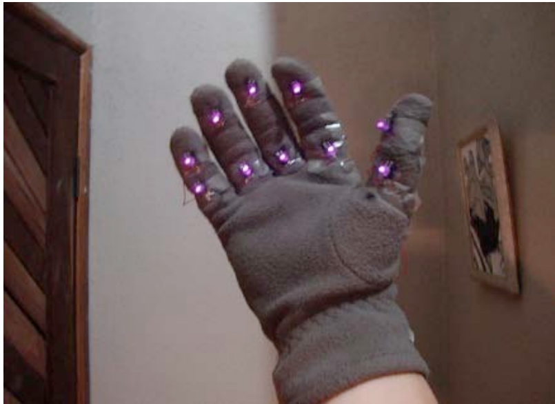
Figura 7: Leds na palma da luva X-GESTUS.
