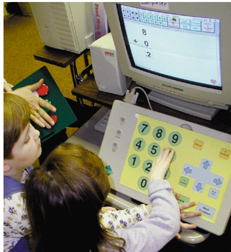
Figura 12 . Exemplo de tecnologia assistiva: teclado de grandes dimensões em membrana para uso por crianças com limitações físicas ( http://computer.yourdictionary.com/assistive-technology )
